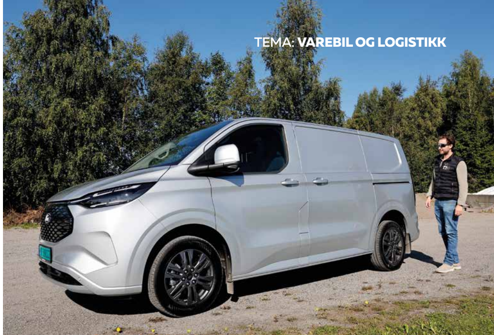
Testbilen er den korte L1-utgaven med 218 hk, 71 kWh batteri og elmotor på begge aksler.
