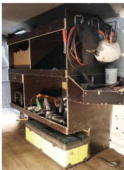
Reolene i varerommet er festet til de originale innredningsfestene på veggene i bilens karosseri.
