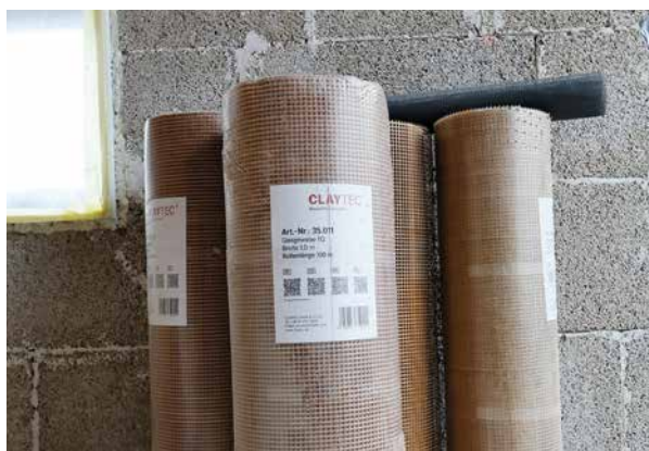
En tynn glassfiberduk legges inn i leirpussen mens den er våt. Den fungerer som armering og bidrar til å stabilisere overflaten og redusere sprekker.
