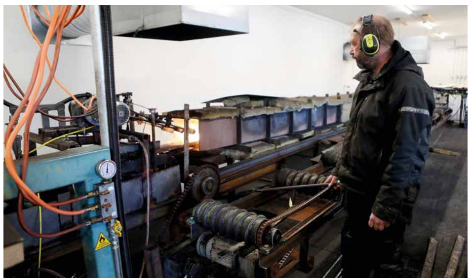
Sveinung Kosberg følger med mens bordene brennes i produksjonslinja i hallen hans på Berkåk sør i Trøndelag.
