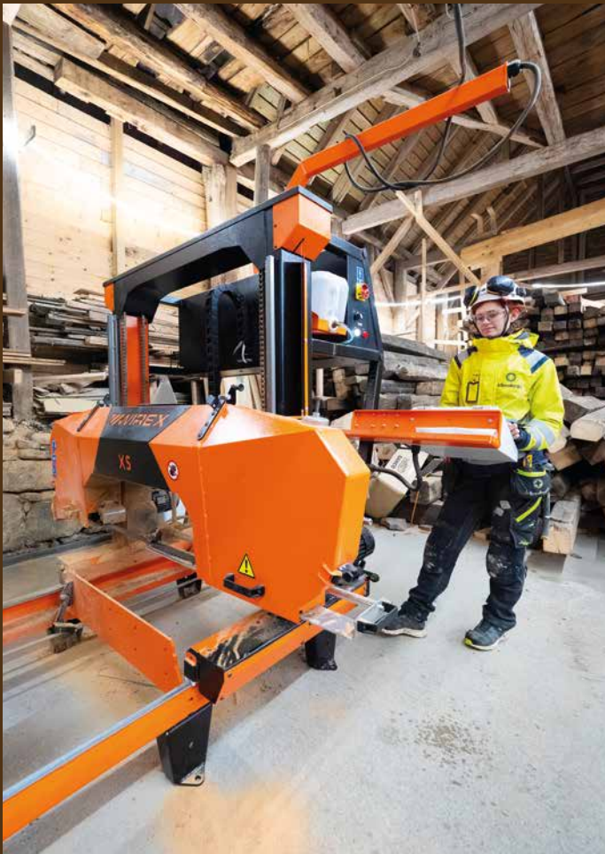
Mari Elise Hoff, voksenlærling fra Klimabygg, forbereder saging av gjenbruksmaterialer med den nyinnkjøpte gårdssagen.
