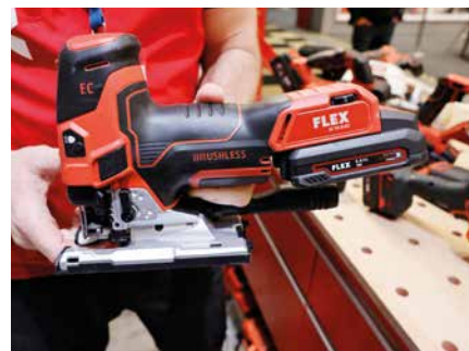
Stikkssagen Flex JS 18.0-EC er en kompakt, batteridrevet modell med børsteløs motor som gir presise kutt og god kontroll i tre og plater.
