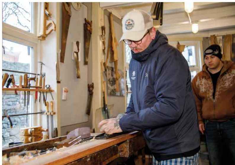
Mikael Wikström, voksenlærling hos Byggmester Sagen, forsøker seg på håndhøvling av profil.
