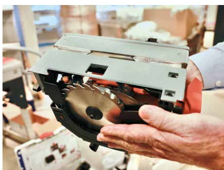
Lav vekt, høy styrke: Såleplater og motorhus er laget av magnesium som leder varme bedre og tåler tre ganger høyere belastninger enn stål.
