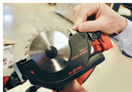
Sagbladet til Mafell KSS 40 18 M bl er 120 mm og den nette kappsagen gir helt presise kutt ned til 40 mm med skinne og 42 mm uten. Med skråsnitt på 45° [med skinne] er kuttdypen omtrent 27 mm.
