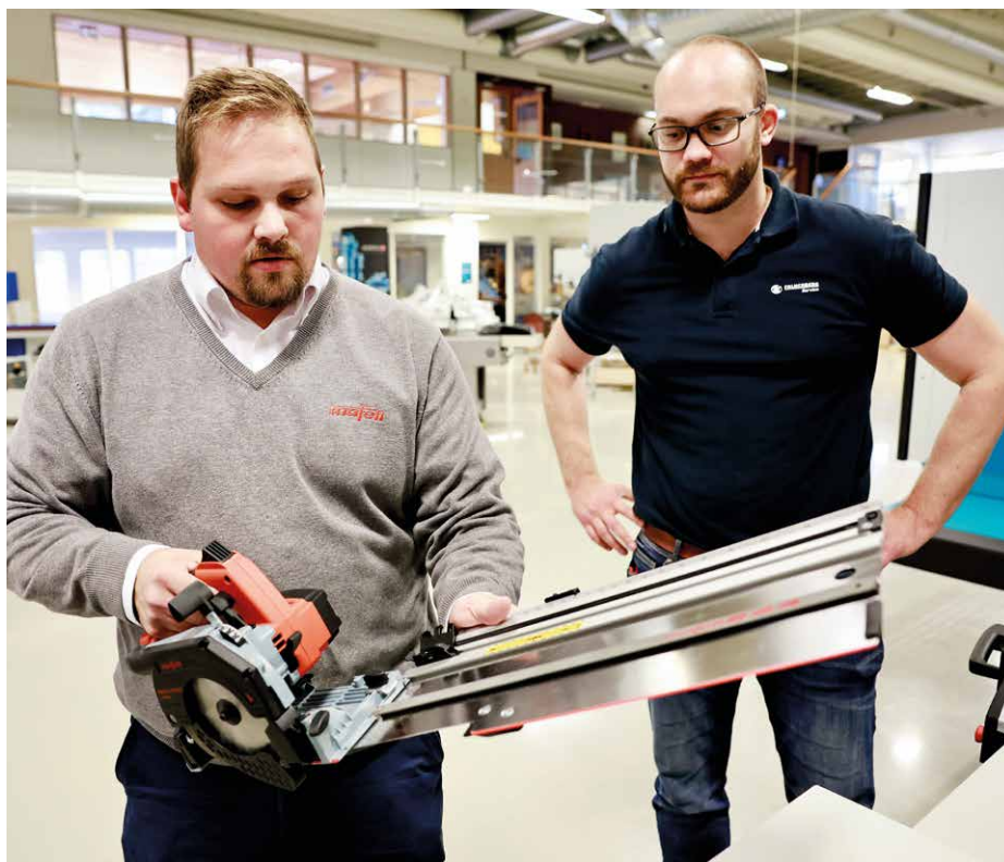
Mafell KSS 40 18 M bl kappsag lar tømrere sage kryss- eller rifter, skinnestyrt kutt, gjæring eller sammensatt gjæring i vinkler opp til 45°, eller til og med dykkutt.
