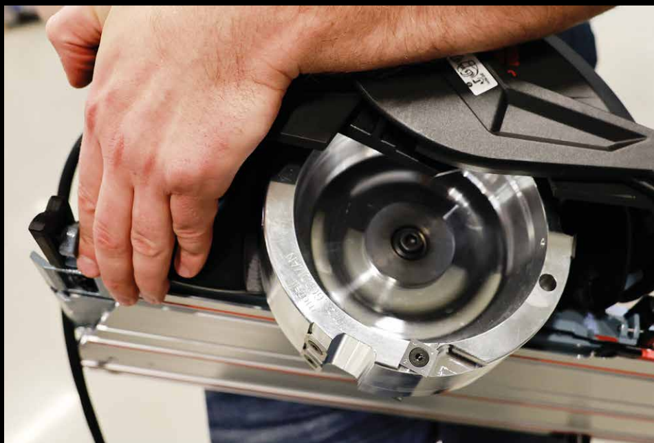
Notfresemaskin NFU 50 er ikke lett med sine 9,4 kilo men effektiviserer restaurering, tømmerbygg, produksjon av ferdige elementer og arbeid på bygg der du trenger presise og brede profiler.
