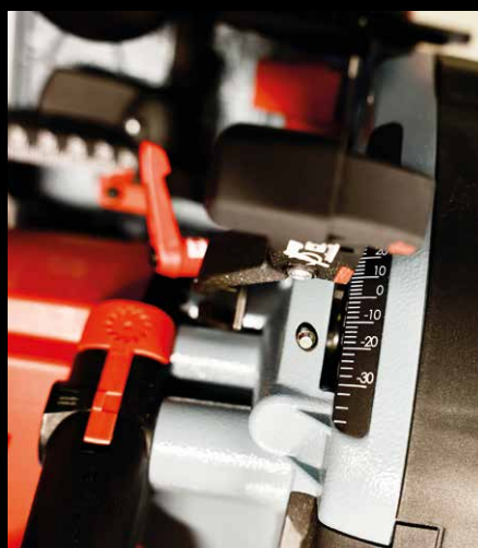
Mekaniske fininnstillinger er en viktig del av treverktøyet til Mafell.
