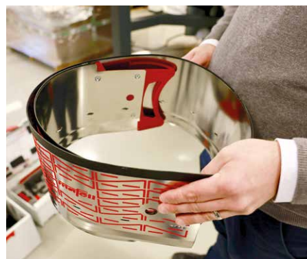
Hurtiglåsen lar deg løsne maskinen fra skinnen i en enkelt, rask handling. Skinnene oppbevares sammenrullet.
