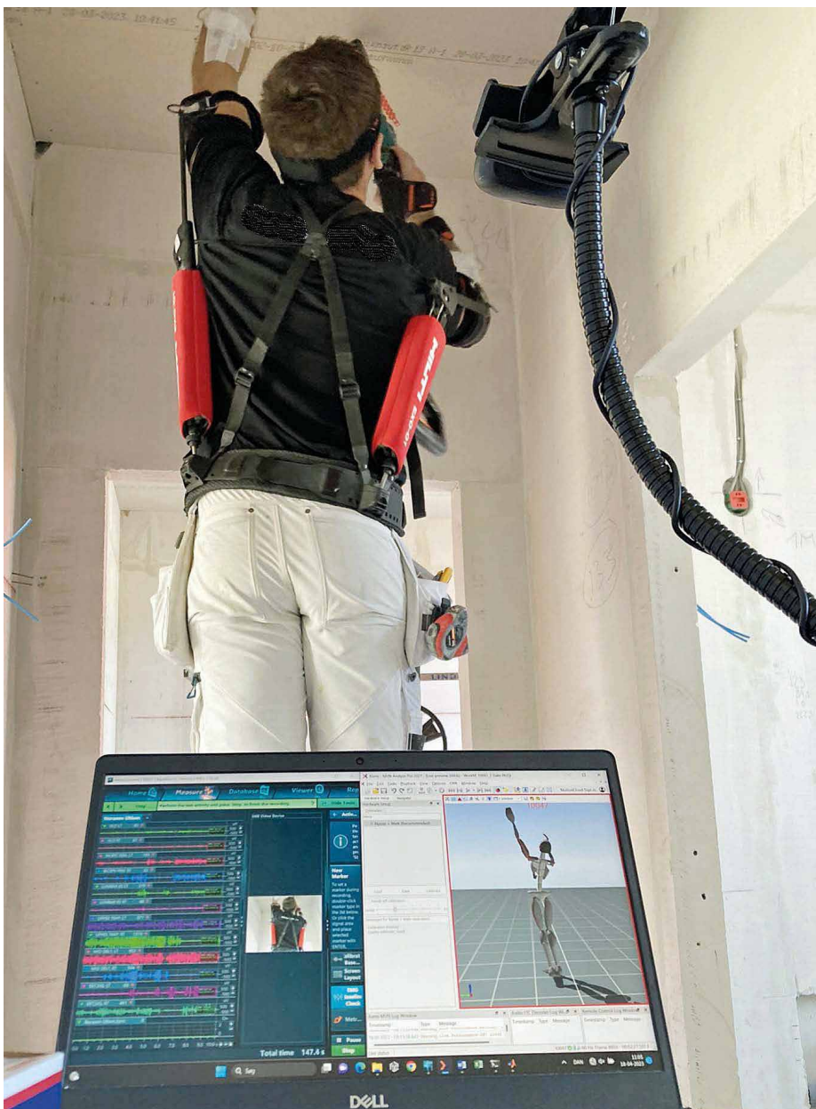
MÅLINGER: 17 bevegelsesmålere og egne målere for muskelaktivitet fulgte med i detalj. Målingene er til venstre på skjermen. Til høyre er en avatar som kopierer bevegelsene til tømreren fortløpende. (Foto: NFA)
