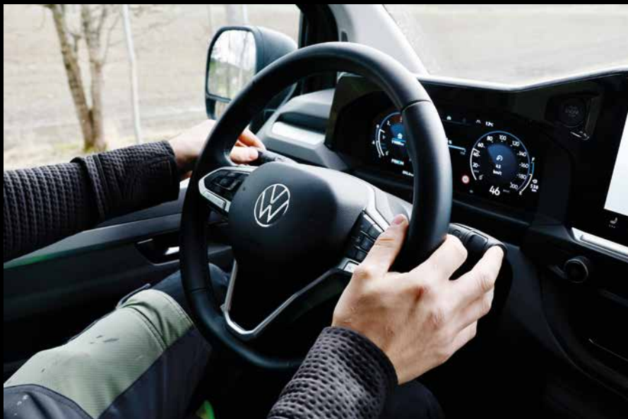
VW Transporter Pluss kan også gires manuelt med hendelen ved rattet – Praktisk i situasjoner der du må ha helt presis kontroll.
