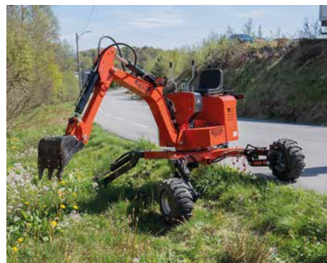
Spider 360 har en B&S 13,5 hk 400cc bensinmotor med elektrisk start som gir en maksimal gravekraft på inntil 940 kg. [Foto: Wee gruppen]
