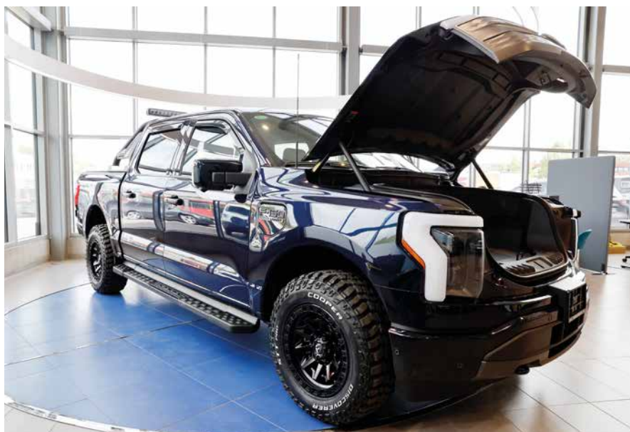
F-150 Lightning har firehjulstrekk, 452 hk, 1050 Nm dreiemoment og akselererer fra 0–100 km/t på under 5 sekunder. Den elektriske rekkevidden er opptil 429 km (WLTP), og den kan hurtiglades fra 15 til 80 % på 39 minutter med en 150 kW lader.
