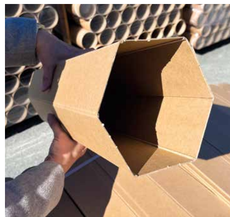
Papprørene gjør det enklere å utføre støpearbeid på steder der tradisjonell forskaling er upraktisk eller tidkrevende. [Foto: Steinhardt]
