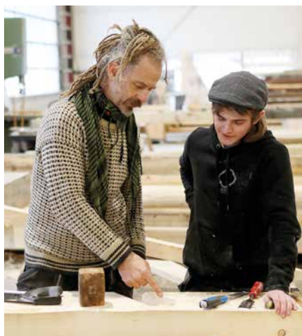
Gjestelærer Richard Andersen forklarer elev Svein Tynnøl hvordan skråbåndet skal felles inn i den ene grinda til grindbygget.
