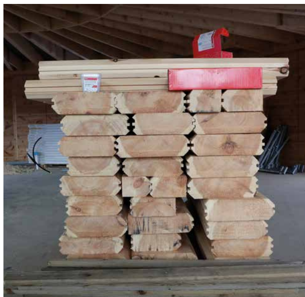
Her ser vi tverrsnitt av tømmeret som brukes til elementer i huset. Legg merke til at det er svært mye kjerneved. Margsiden ble vendt ut i hvert enkelt element.
