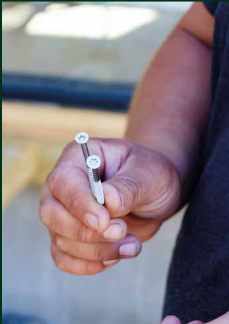
- Spilekledning er nøyaktig arbeid: Det går 19 furuspiler og 95 skruer på meteren.
