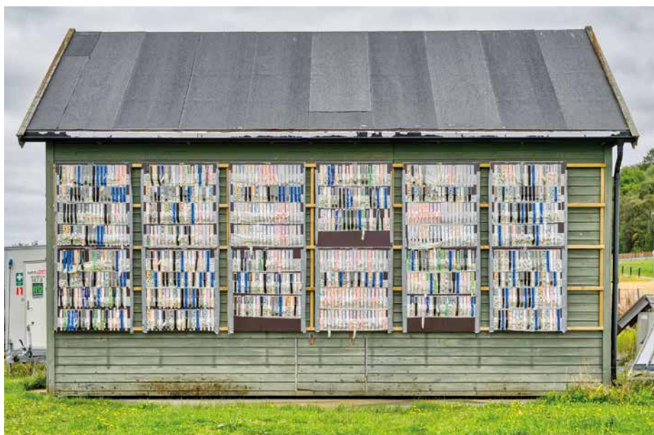
Utendørs eksponering av teip for naturlig aldring i TightEN-prosjektet. [Foto: Nicola Lolli/SINTEF]
