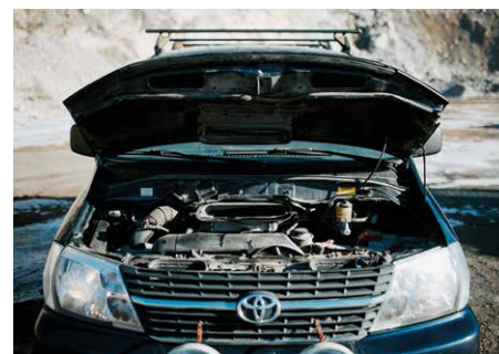
Giskås sin Toyota Hiace fra 2009 har firehjulsdrift og den slitesterke 4D 2,5 liter dieselmotoren med 117 hk.
