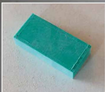
Slike gummiklosser legges på gulvet for å hindre trinnlyd.
