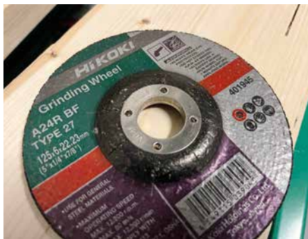
Årstallet som er preget inn i den innerste ringen viser utløpsdatoen for slipeskiva.
