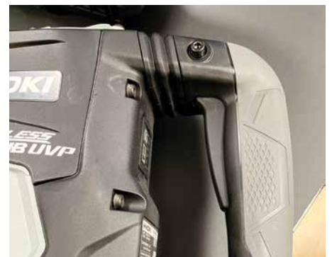
Forkortelsen UVP betyr at kombihammeren har innebygd vibrasjonsdemping.
