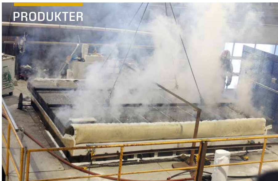
Branntest av 3-doble gitterdragere med vertikallast. (Foto: Dag Olav Snersrud, RISE Fire Research AS)
