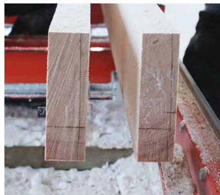
Ferske materialer i 2,5 x 8 tommer, skjært fra den innerste delen av treet.
