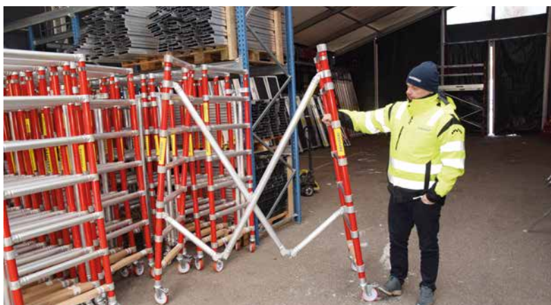
Snappy rullestillas er sammenleggbart, lett å sette opp med lemmer i ønsket høyde, forklarer Frode Mathiassen.
