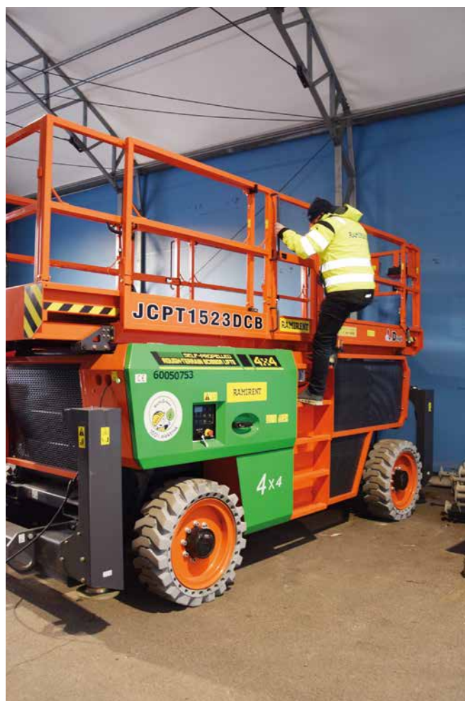
Den terrenggående liften går på strøm og én lading holder hele arbeidsdagen.
