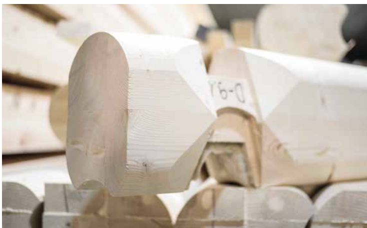
- For at lafteknuten skal bli ekstra tett og ikke gi luftlekkasjer, gir vi den en ekstra innvendig fresing og legger inn et tettebånd.
