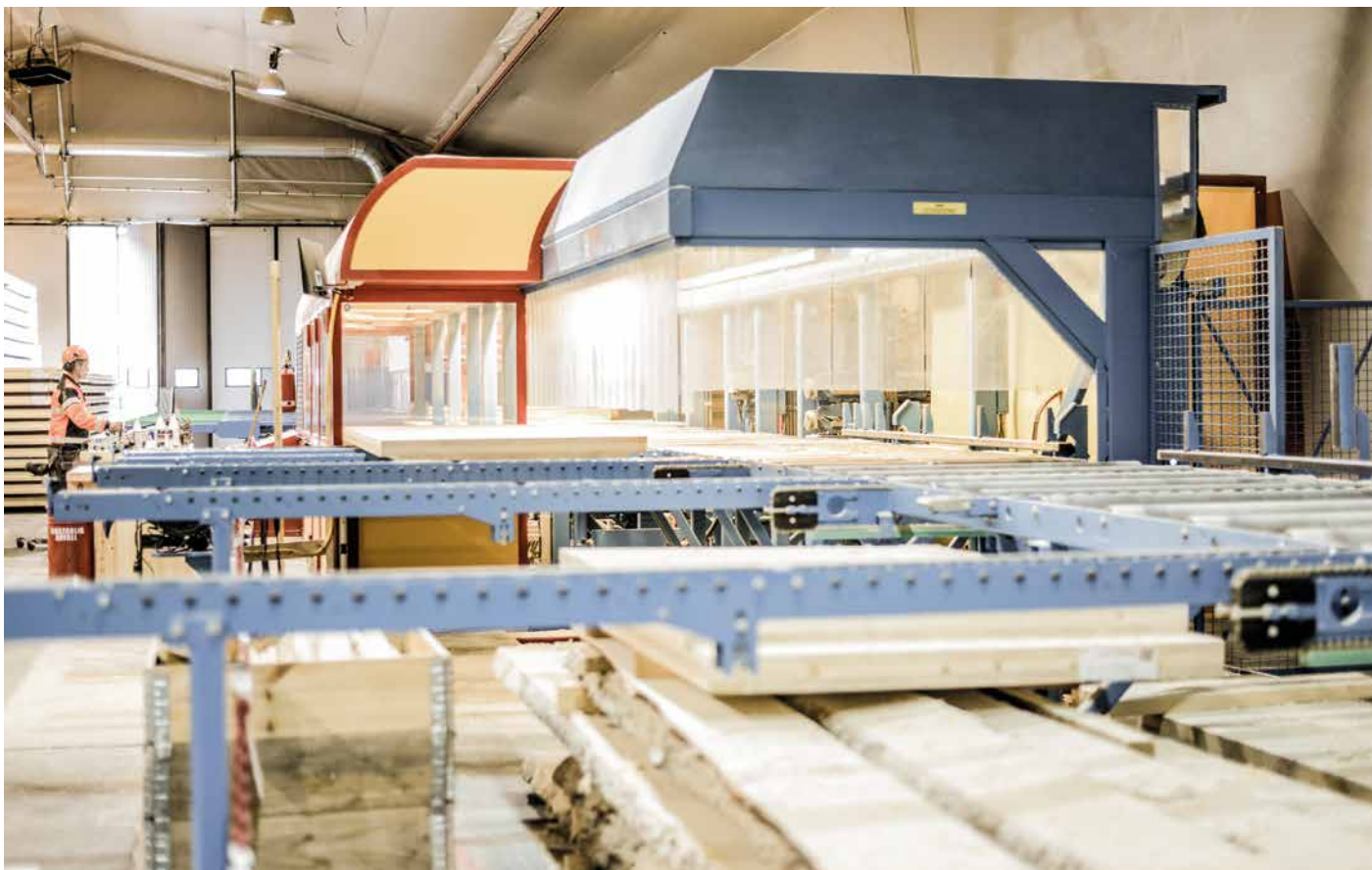
Med Telemarks kanskje største CNC-maskin kan Haukeli levere elementer og precut til hele bygg, trapper, delkomponenter og bærekonstruksjoner.
