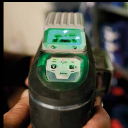
Mange lasermålere varsler deg om noe er galt med dem. Ofte kan du selv sjekke og løse problemet ved å rense verktøyet og styre en kalibrering via appen.
