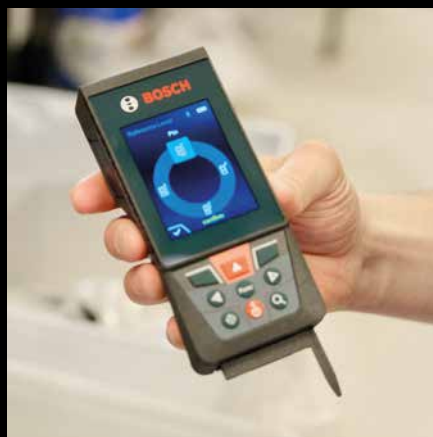
Finner ikke 0-punktet? Mange avstandsmålere har en liten arm som kan felles ut - da legger måleren automatisk til 5 cm på avstanden og du har et fast 0-punkt å måle fra.
