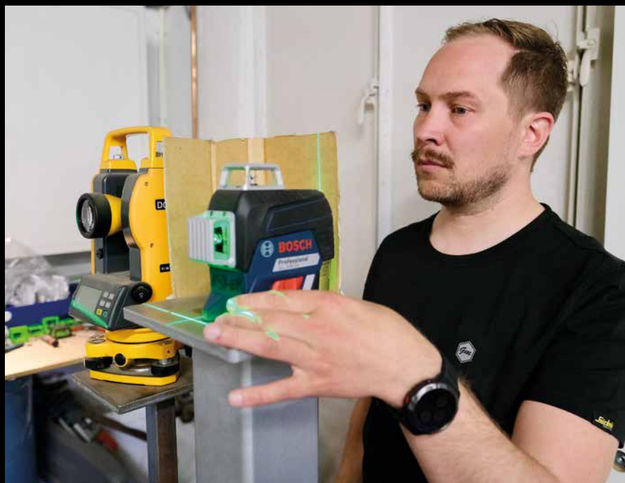
- De fleste lasermålere - uansett pris - er nøyaktige. Presisjonen varierer fra 0,8 mm avvik hos en rimelig avstandsmåler som måler inntil 10 meter til 0,3 mm avvik hos en proff krysslaser som måler inntil 30 meter, forklarer Espen Grønvold i Grønvold Maskin.
