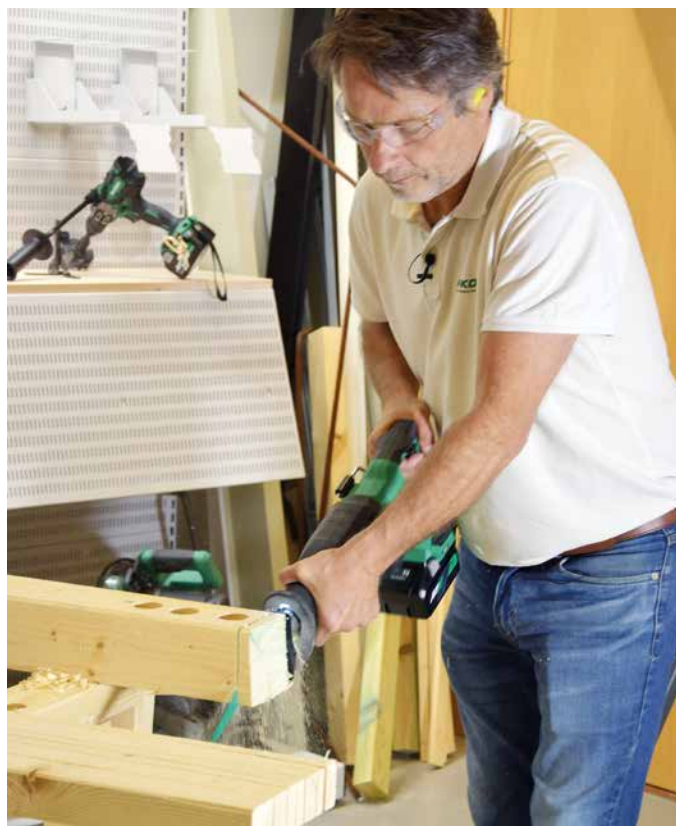
Bajonettsaga skjærer seg raskt gjennom bjelkestykket.
