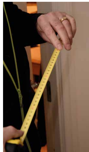
GODE HJELPEMIDLER: Målebåndet har punkter for hver cm og for hver 10 cm. Vaterpasset gir lyd når det er i vater.
