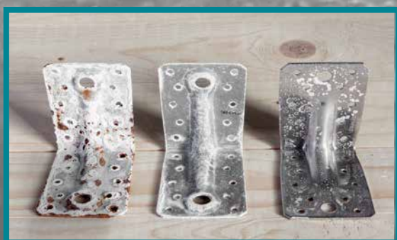
Standard ZPRO A4 syrefast etter 1400 timer i salttåke kammer
