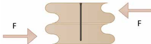
Figur 2: Skjærkrefter vinkelrett på skruen
