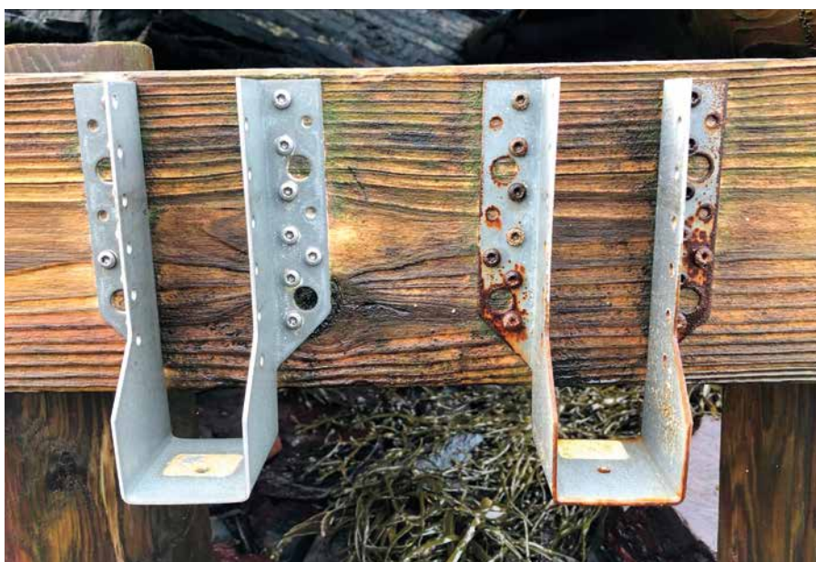
Etter ett år på en bjelke i brygga, ser Zpro-beslaget ut som nytt, mens rusten er begynt å prege det galvaniserte. (Foto: Bjarne Nordvik)
