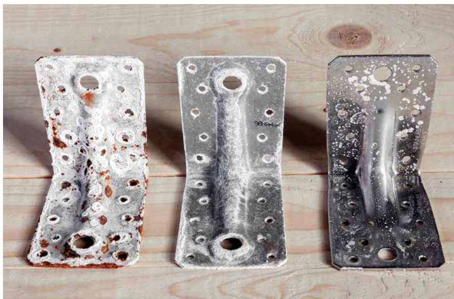
Tre beslag har gjennomgått den framskyndete prosessen med 1 400 timer i salttåke: Det pre-galvaniserte beslaget (t.v.) har rustet, Zpro er litt påvirket, mens det syrefaste knapt er påvirket. (Foto: Bjarne Nordvik)
