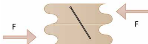
Figur 3: Skråstilt bruk av skruen
