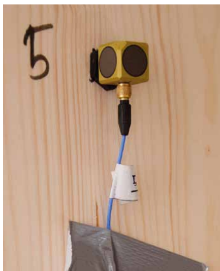
På veggene er det festet sensorer som skal måle lyd fra naboenheten.
