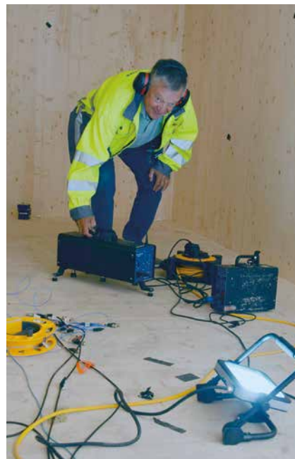
Lars Strand demonstrerer bankemaskinen som blir brukt for å måle trinnlyd-gjennomgang til underliggende enhet.
