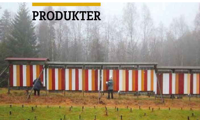
Testing av linoljemalinger på prøvefeltet til Norsk Treteknisk Institutt i Sørkedalen i Oslo. (Foto: Jon Brønne, Riksantikvaren)
