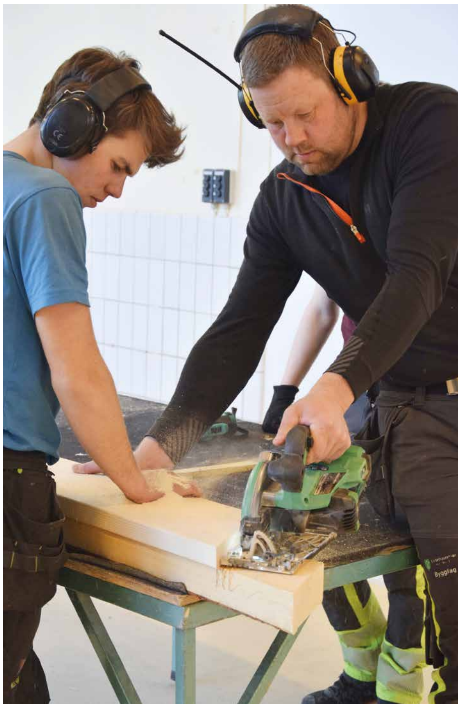
Med sirkelsag kan du skjære renner i planken slik at det blir lettere å få til tilpasningen, demonstrerer lærer Jens Martin Holme for Anton Martinus Haugen Nustad.
