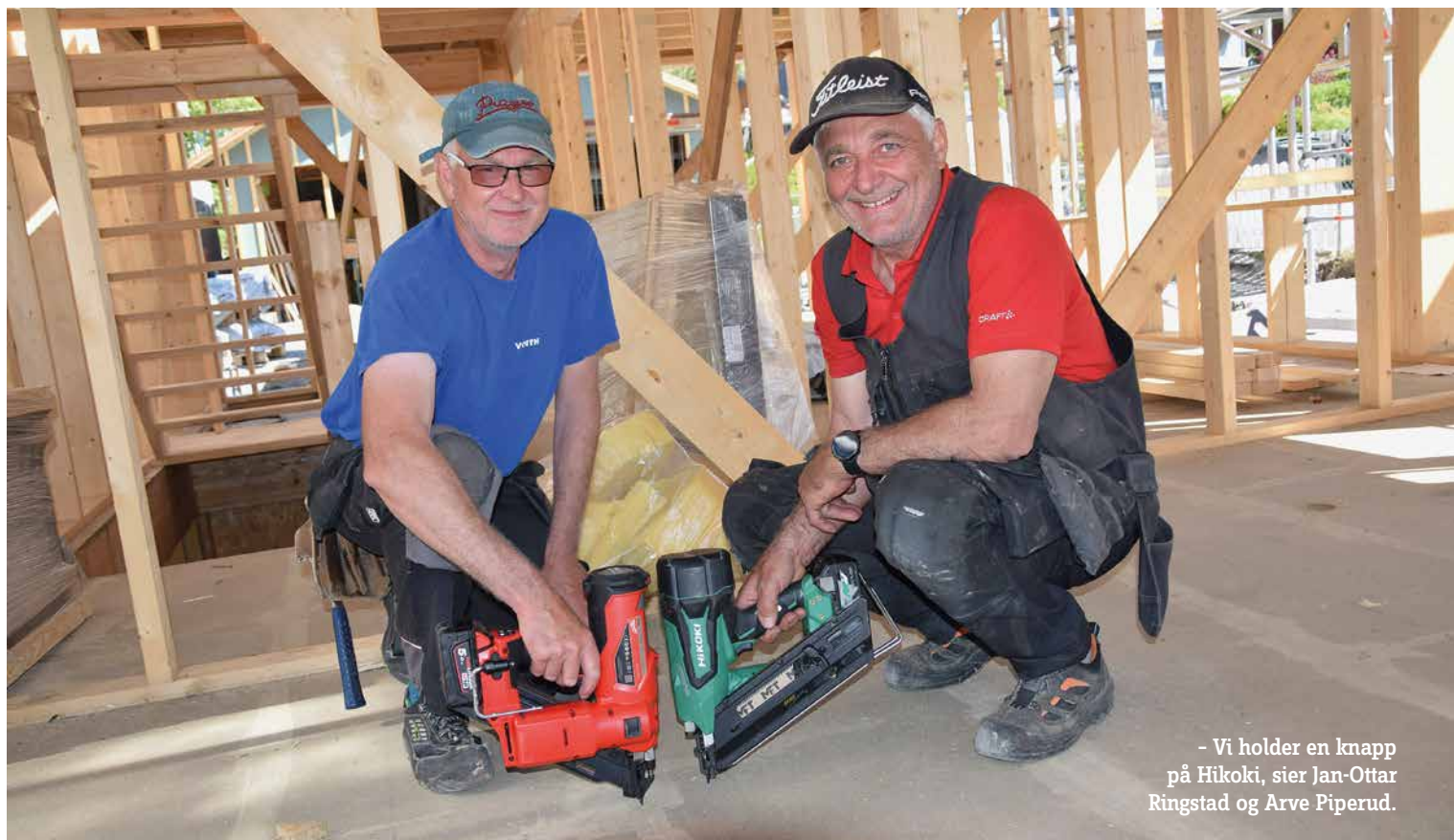
- De batteridrevne spikerpistolene blir for tunge om man skal jobbe med dem over hodet hele dagen, demonstrerer Jan-Ottar Ringstad.
