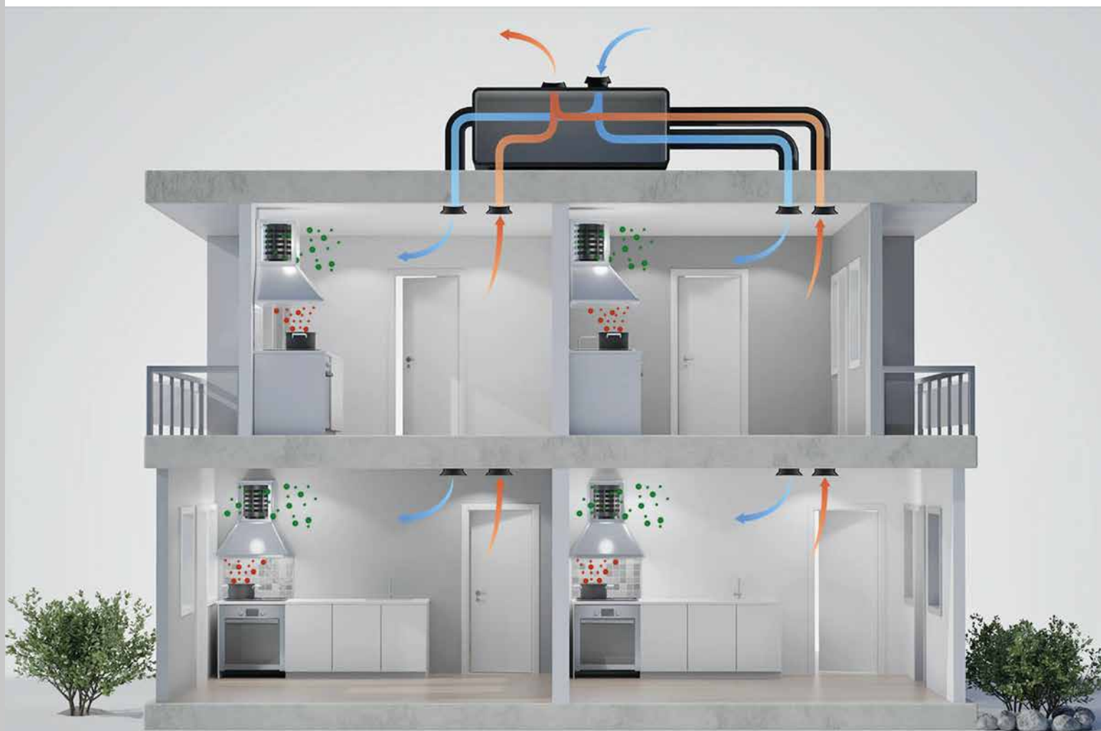
Plasmafilteret gjør at flermannsboliger unngår et felles avtrekkssystem fra kjøkkenet. (Illustrasjon: PlasmaMade)
