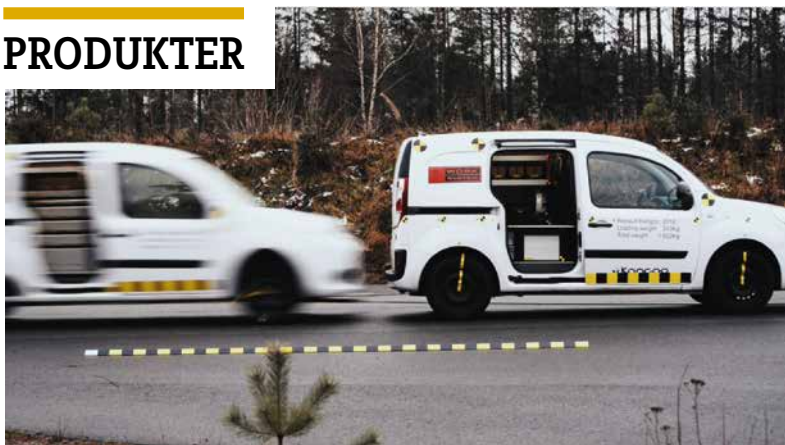
Work System har utviklet en egen kollisjonstest med komplette biler for å simulere kraftig påkjørsel bakfra. (Foto: Work System)
