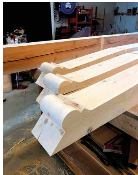
Sperrer er skjært til som de opprinnelige. (Foto: Sondre Dahlin, Egil Norli AS)
