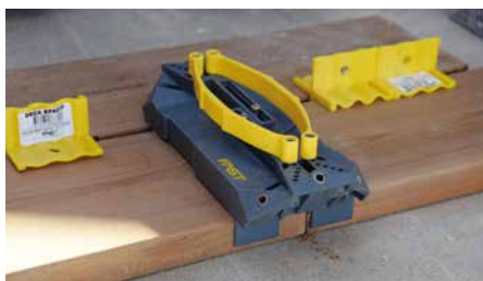
Plastmaterialet i Fast Deck Tool gjør verktøyet lett, men med usikker kvalitet.
