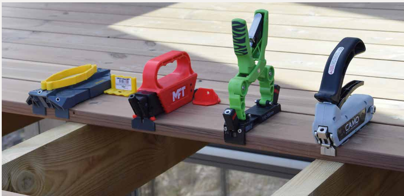
FIRE VERKTØY I TESTEN: Fast med avstandsrikke, MFT med avstandsrikke, Essve HSD og Camo.
