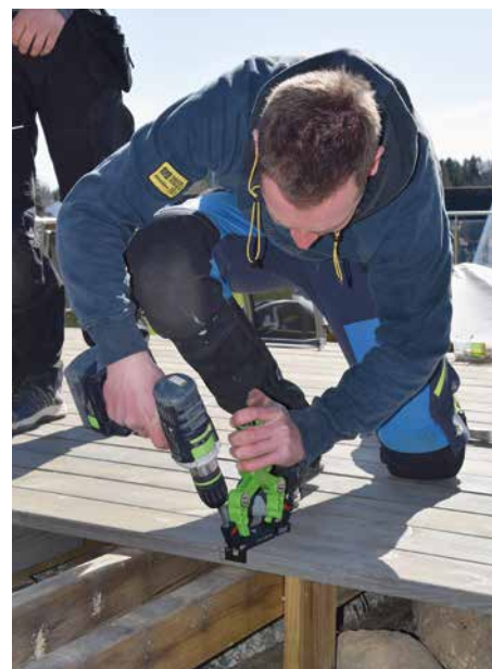
VANSKELIG: Håndtaket står opp på Essve HSD og gir en vanskelig arbeidsstilling.
