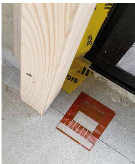
Fuktsensoren plasseres ut på steder i konstruksjonen hvor de dyreste skadene kan oppstå.
