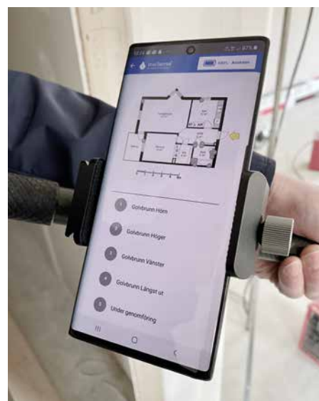
Hver installerte fuktsensor legges inn i plantegningen.
