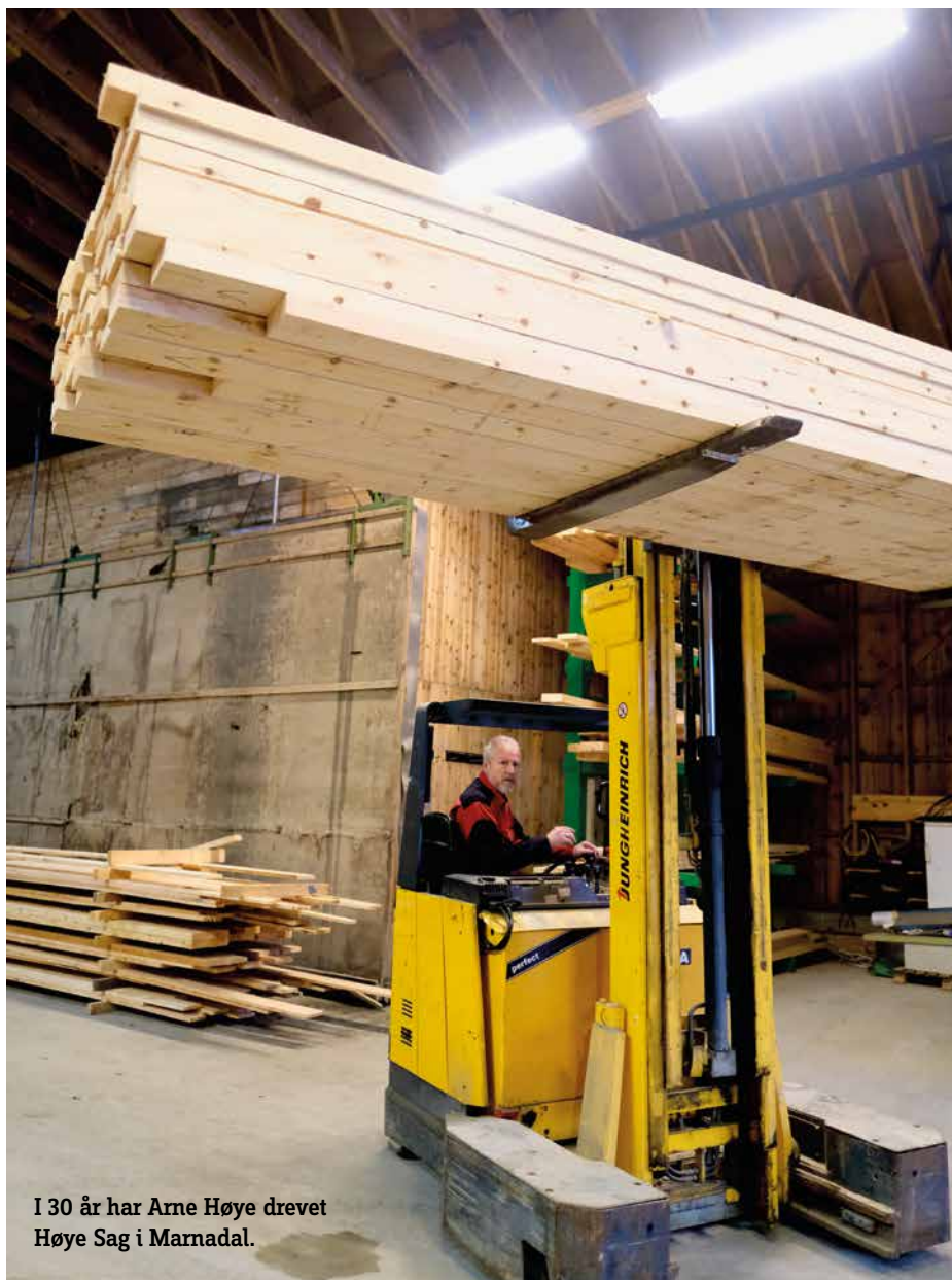
På Høye Sag sorteres kjerneveden videre, skjæres til og får eventuelt den populære etterbehandlingen med jernvitriol i grunningsmaskin.
