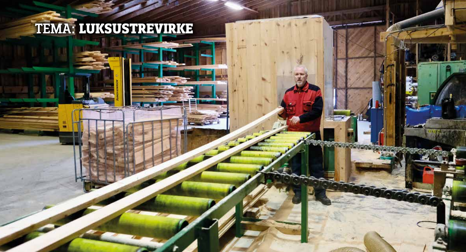
På Høye Sag sorteres kjerneveden videre, skjæres til og får eventuelt den populære etterbehandlingen med jernvitriol i grunningsmaskin.
