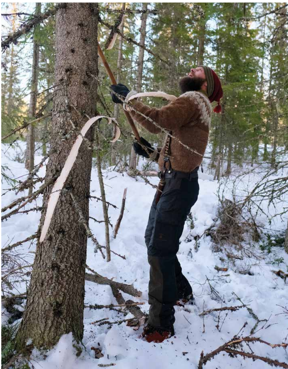
– Det er ikke vanskelig å stripebarke. Du trenger tid, en barkespade og pågangsmot, sier tradisjonshåndverker Marius Holje.
