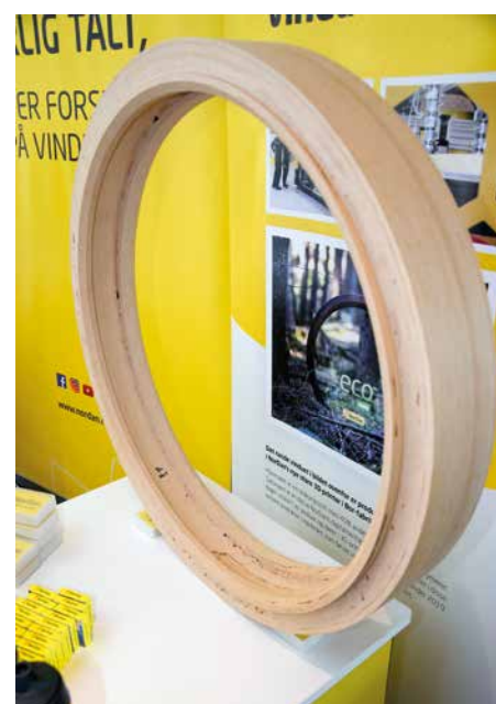
En prototyp av et rundt vindu fra 3D-printeren ble vist fram på Systemhus' kongress i juni.
