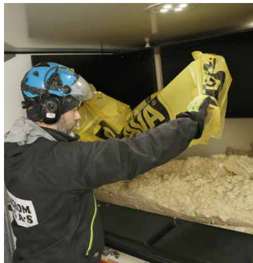
Ragnvald Smidesang ved blåseaggregatet i kassebilen som de bruker når de er ute på innblåsningsoppdrag.
