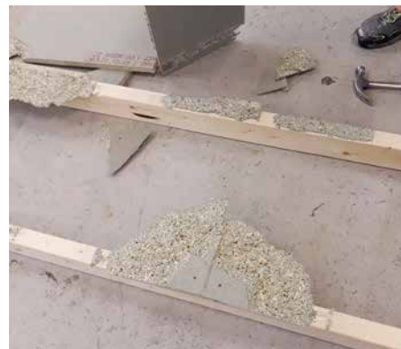
Sterkt lim sørger for at rester av sponplater sitter igjen på tilfærerne. (Foto: Jostein Flå)
