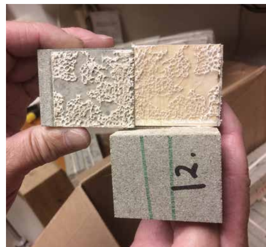
Prøvestykke fra en test med tykk fuge. Limfugen viser at det dannes større hulrom og små «kratrer» når limsubstansen tørker ut, en tendens som kan variere fra limtype til limtype. Omfanget av dette påvirker styrken i forbindelsen.
