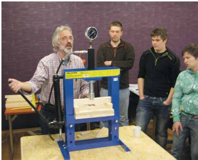
På en elegant måte kombinerte han praksis og teori i undervisningen på pilotkurset for Etterutdanning for tømrere desember 2011. Her med en hydraulisk presse for å teste trevirkets bruddstyrke og indre knusing i spikersammenføringer. (Alle foto: Øivind Ørnevik)
