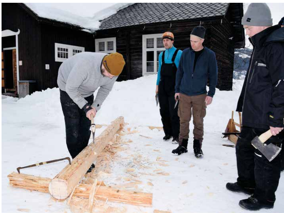
Materiallære er ett av flere emner i studiet. Her er studenter i årets kull i gang med å kante tømmer som de har vært med på å felle.
