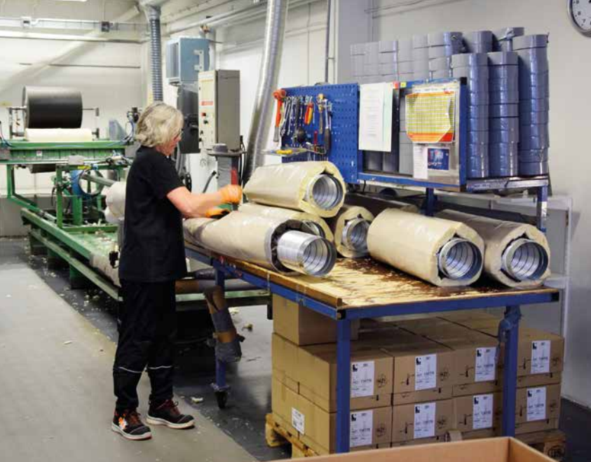
Ventilasjonskanaler isoleres for å dempe støy.
