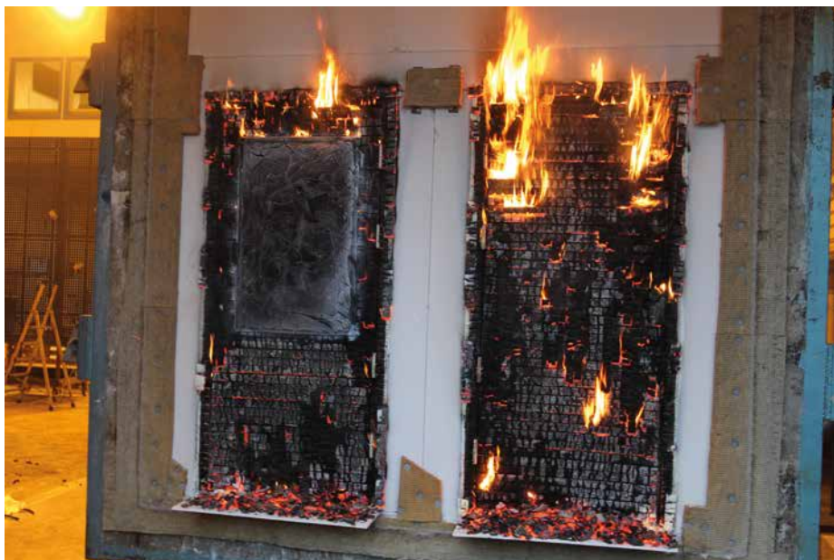
Fra brann testen: Dørbladet av 40 mm massivtre bøyer seg for mye når massivtreskiven blir ubalansert, altså når 1 av 3 lag er brent bort etter ca 10-12 minutter. Det gjør at røyktettheten svikter først. (Foto: Green Advisers)
