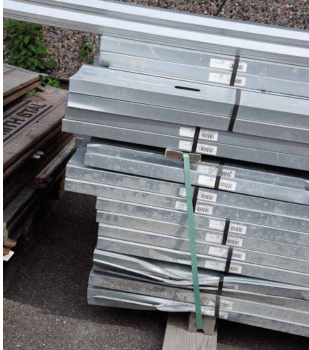
Hele pakka med stålstendere ble kassert selv om det bare var to av stenderne som var skadet.
