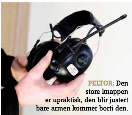
PELTOR: Innstillingen skjer via to knapper på høyre klokke. Hodesettet kan lagre opptil 10 DAB-kanaler.
