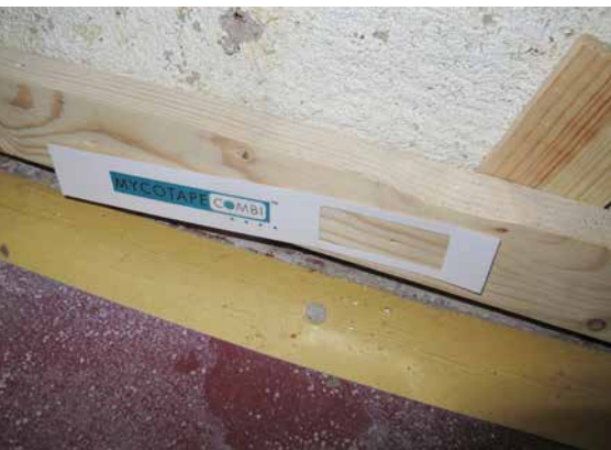
TEST for muggvekst med tape på trelekt.
