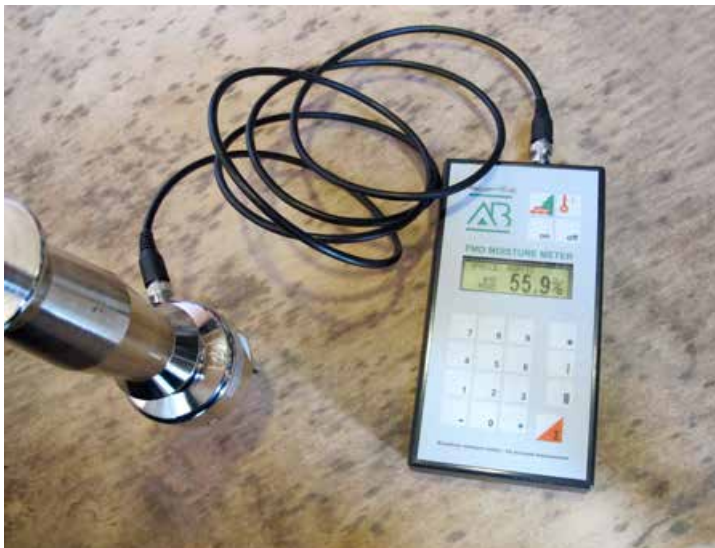
TRE: Måling med hammerelektrode i tresvill/trebaserte plater.
