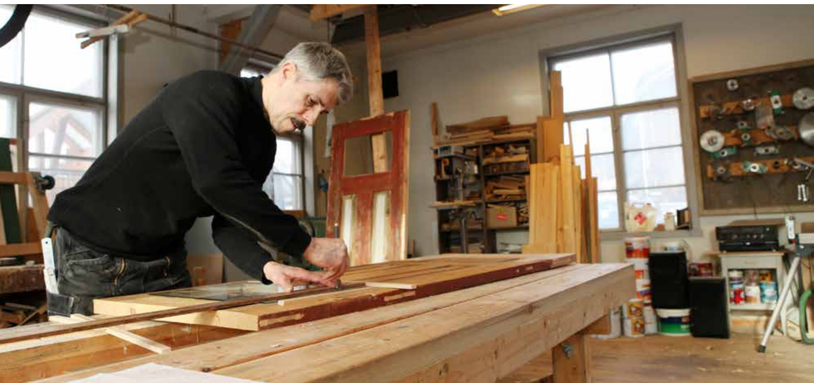
Olaf Piekarski, som er leder for Antikvarisk Verksted på bygningsvernssenteret, setter i stand ei gammel dør.
