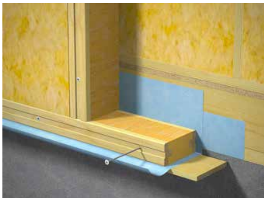
GLAVA Pluss består av stendere i stuket glassull (stående fibre) med pålimt treverk. Stuking av glassull gir høy trykkstyrke kombinert med lav vekt. (Illustrasjon: Glava)
