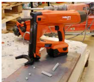
Kristian Halvorsen prøver boltepistolen og kan konstatere at rekyl og støy er mindre enn for andre typer. Kollegaen Robert Krzyzanowski (t.h.).
