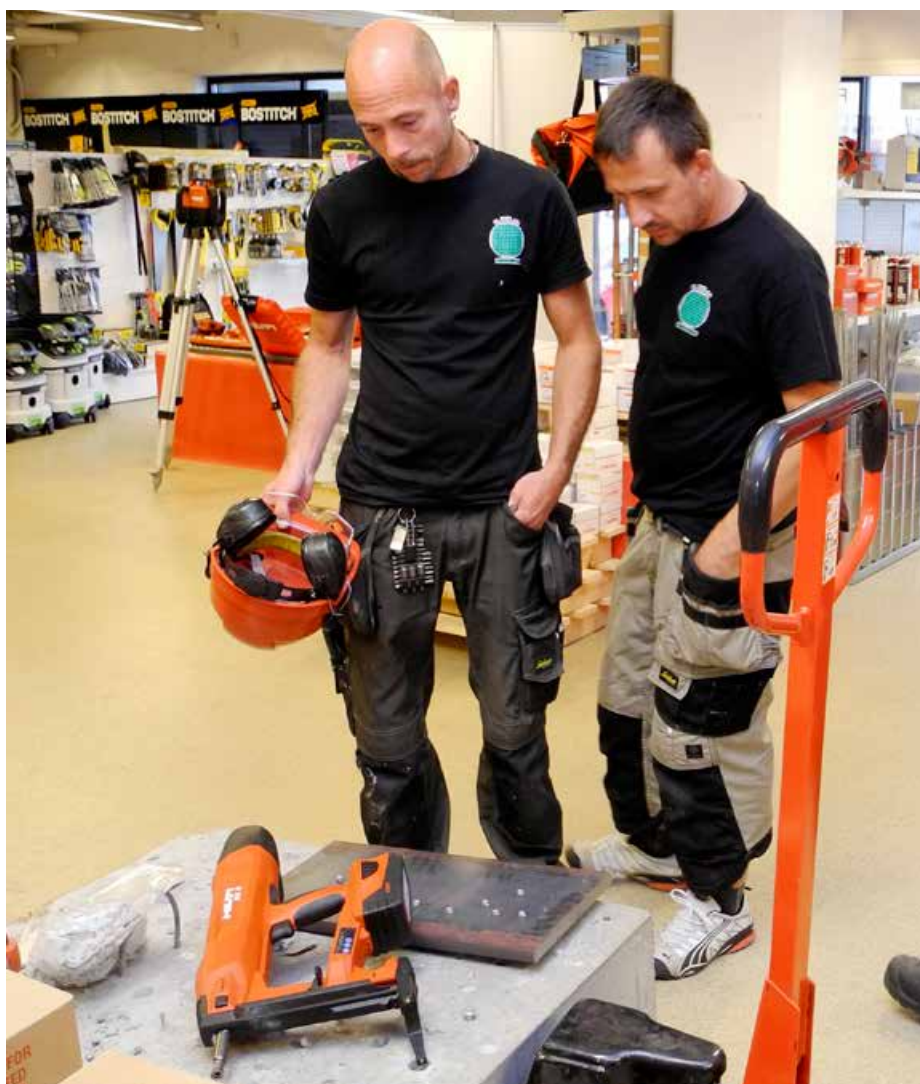
Kristian Halvorsen prøver boltepistolen og kan konstatere at rekyl og støy er mindre enn for andre typer. Kollegaen Robert Krzyzanowski (t.h.).
