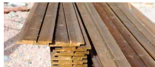
Bygget kles med Møre Royal kledning.
