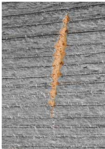
Et risp med kniven viser at treet er like friskt under den grå overflaten.
