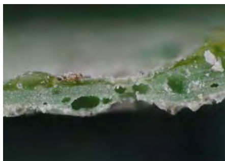
Membran påført med to strøk, 0,3-0,5 mm tykk, full av porer og oppfyller ikke fuktetthetskravet.
