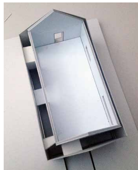
Modellen viser vær huden som går rundt hele huset, og er separert fra den isolerte bygningskroppen.
