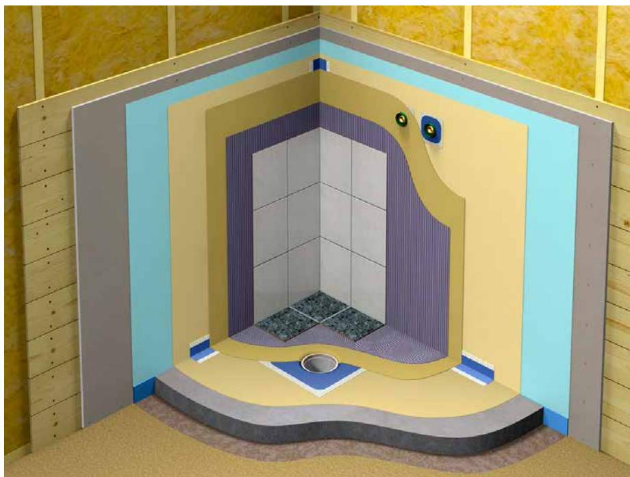
Slik kan et våtrom bygges med rupanel og gips som underlag for membran, flislim og flis, ifølge Håndverkernes Våtromsveileder.
