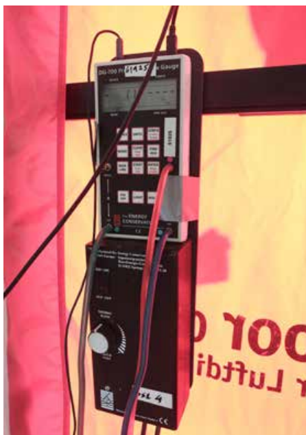
Med undertrykk i bygget kan luftlekkasjer påvises helt nøyaktig med varmekamera og probe.
