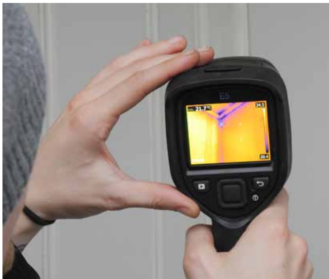
Den lille fargen på skjermen viser at det trekker kaldt rundt listene.
