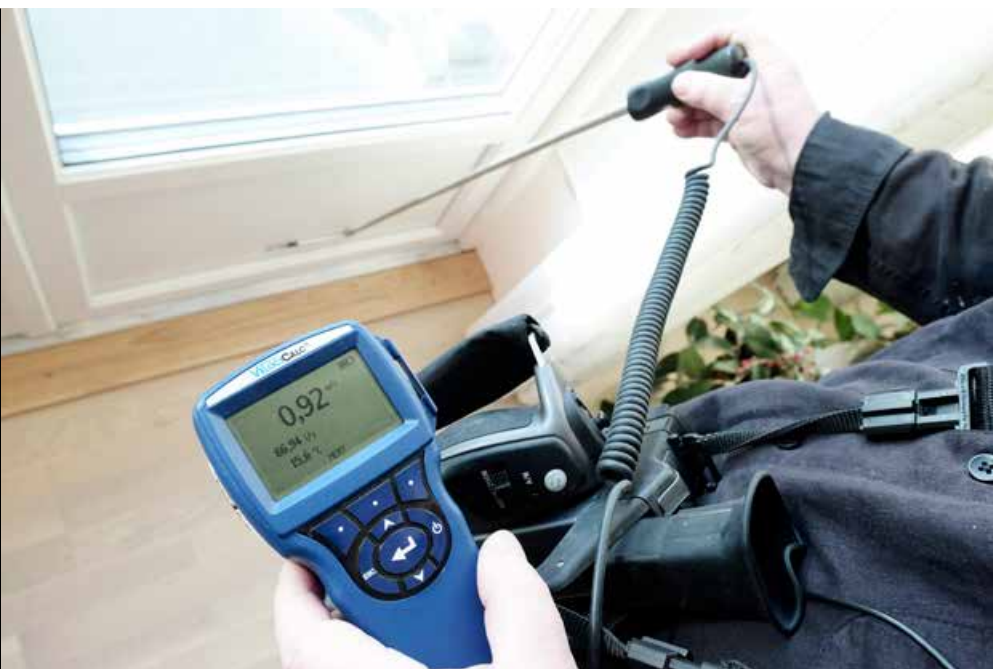
Med undertrykk i bygget kan luftlekkasjer påvises helt nøyaktig med varmekamera og probe.
