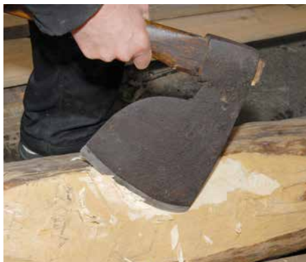
Agder-bila er ei lafteøks med en særegen form som fortsatt blir brukt i Agder.
