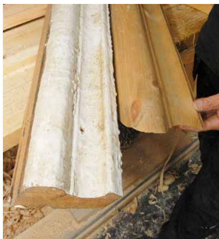
Listene som markerer etasjeskillene er kopiert med selvlagde høvler.
