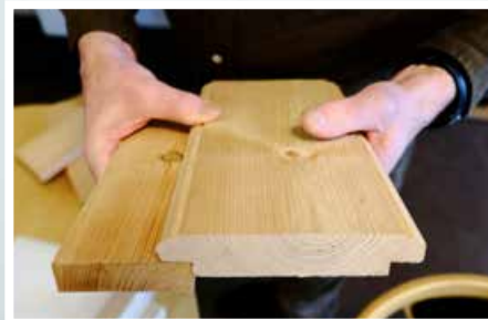
– Dette er 28 mm bord av kjernefuru som er spesialtegnet og produsert til oss på det lokale sagbruket. Bare vi tørmere som ser det, sier Hansen.
