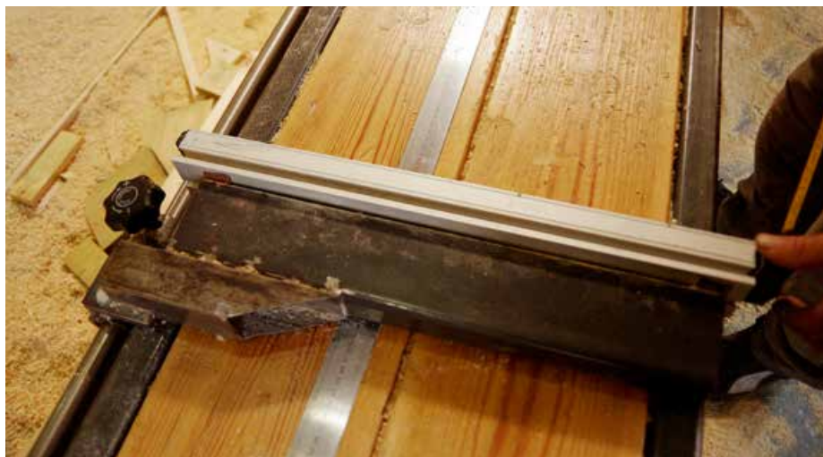
På gjerdesaga har firmaet bygd inn ei egen styring for å få topp- og bunnkapp parallelle på ukanta bord. I anlegget er det felt ned et måleband med avstand til bladet.
