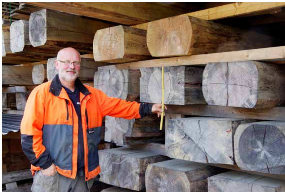
Lafteplank i 20, 25 og 30 cm dimensjon ligger på vent for tørk og nye ordre. Etter skur og barking blir lageret delvis lagt opp med lastebilkran.
